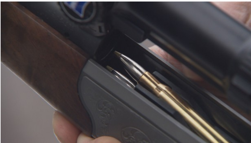
Alternativen zu Blei: Immer mehr Jäger schiessen bleifrei, hier mit einem Projektil aus einer Kupfer-Zinn-Legierung. SRF
